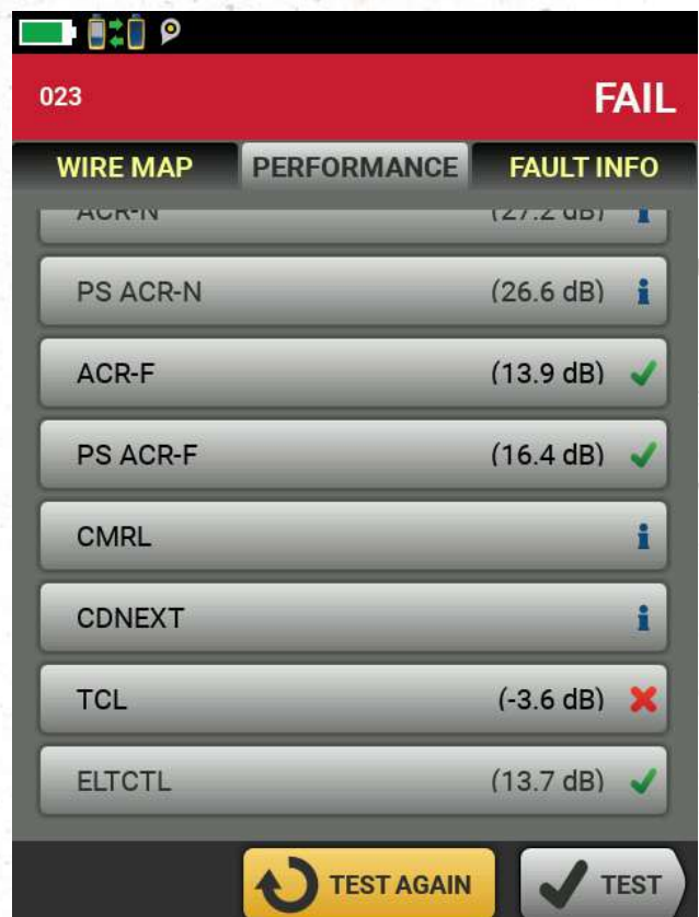
DSX CableAnalyzer affichant les résultats d'un test de niveau E3 échoué. Notez la défaillance TCL.
