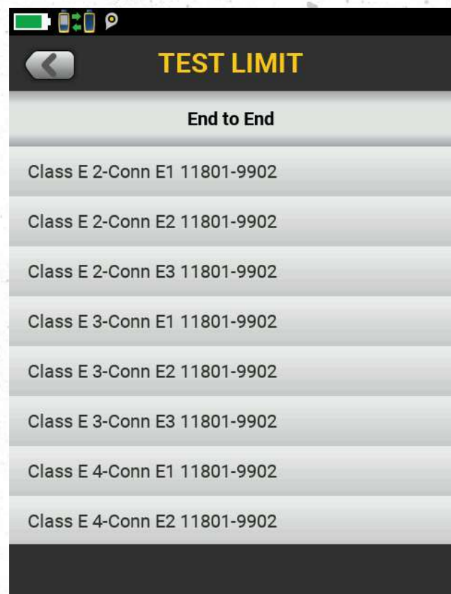
Écran du DSX CableAnalyzer™ affichant les limites de test pour différentes configurations de câbles de bout en bout, notamment les limites E1, E2 et E3.
